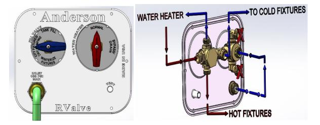
**CITY FILL TANK-** TO FILL STORAGE TANK FROM PRESSURIZED CITY WATER
